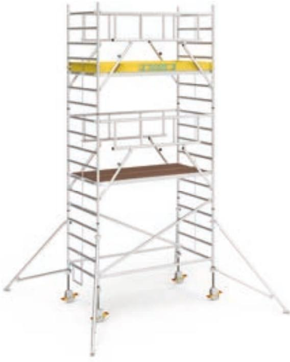
Maximale Arbeitsfläche, sicherer und schnellerer Aufbau durch vorlaufendes Geländer, geringen Plattformabstand und weniger Einzelteile. Sicherer und schnellerer Auf- und Abbau durch vorlaufendes Geländer (anstelle Geländer und Diagonalstreben) und Plattformen im 2 m-Abstand.
